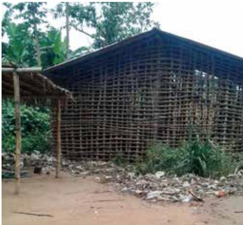
Photo 8 : les sticks utilisés pour la construction d'une maison.
